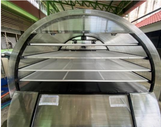
ภาพที่ 7 การติดตั้งแผ่นโพลีคาร์บอเนต
