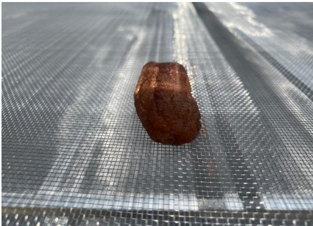
ภาพที่ 13 การเปลี่ยนแปลงของกล้วยน้ำว้า หลังตากในตู้อบพลังงานแสงอาทิตย์
